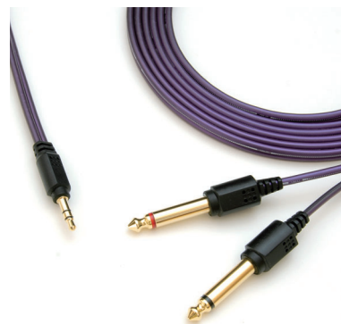
stct_02_3362_300 3.5 3p - 6.3 2p(L/R) 導体：銀メッキPCOCC 絶縁体：PE シールド：OFC ジャケット：PVC プラグ：金メッキ端子 長さ：3.0m JAN：4534165013767
