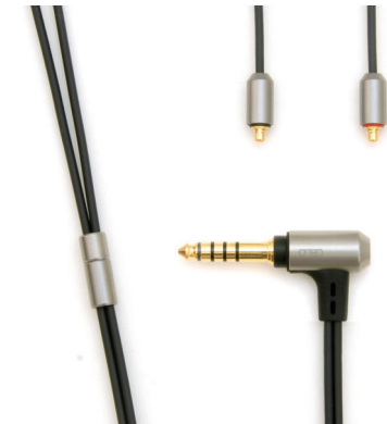
irect_06_b14m_120 タイプ：4.4 5極プラグ - mmcX (l/r) 導体：高純度無酸素銅 ジャケット：TPU プラグ：4.4 5極 金メッキ仕上 コネクタ：mmcX 金メッキ仕上 金属スリーブ：チタン (分岐内部アルミ) 長さ：1.2m JAN：4534165014276
