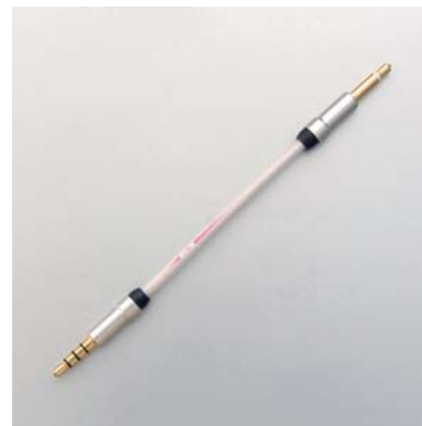
cox_c_01_3432 3.5 4極 - 3.5 2極 銀メッキPCOCC導体 発泡ポリエチレン絶縁 アルミテープ+銅シールド 長さ:0.1m jan:4534165012685
