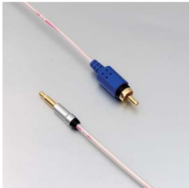
cox_c_01_32r 3.5 2極 - rca 銀メッキPCOCC導体 発泡ポリエチレン絶縁 アルミテープ+銅シールド 長さ:0.75m jan:4534165012678
