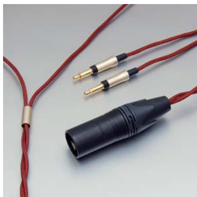
hpct_03_blx3_300 4pin xlr プラグ - 3.5 モノプラグ(l/r) 6n+4n 4芯ツイスト構造 ポリエステル糸編組ジャケット 金メッキ仕上げ端子 長さ:3.0m jan:4534165012906
