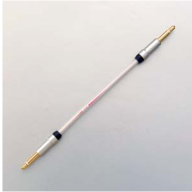
cox_c_01_3232 3.5 2極 - 3.5 2極 銀メッキPCOCC導体 発泡ポリエチレン絶縁 アルミテープ+銅シールド 長さ:0.1m jan:4534165012661
